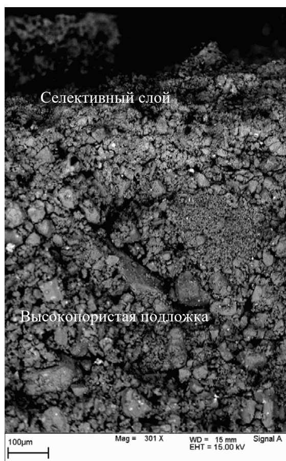
Рис.11 Микрофотография приповерхностной области образца.
